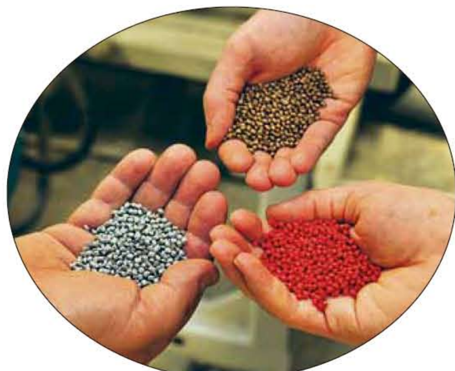
Termoplastisia luonnonkuitulujitteisia granulaatteja (nk. ”pellettejä”).
